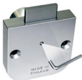
когда он закрыт. Регулируя шестигранным ключом (1,5 мм) винт на задней стенке замка, можно перенастроить эту функцию и сделать так, чтобы ключ можно было вынимать как в закрытом, так и открытом состоянии замка.
